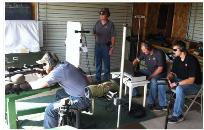
Les ingénieurs de chez Hornady ont utilisé un radar Doppler pour découvrir les effets de l'échauffement aérodynamique et pour confirmer l'efficacité de l'insert Heat Shield.
