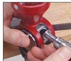
Une simple pression sur un bouton libère l'insert de mesure sans en modifier le réglage. Plus besoin de refaire un réglage quand on change de poudre ou de calibre.
