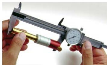
Détermination du bon diamètre de l'épaulement : Si vous ajoutez le diamètre du collet avec le diamètre de l'épaulement et divisez le tout par 2, vous obtiendrez la valeur la plus proche pour le centrage.
